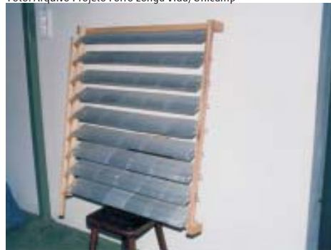
Persianas feitas com as caixas longa vida (acima) diminuem a entrada de calor, como mostra o desenho abaixo
